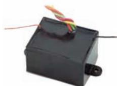
Реле предназначено для автоматического подъема транцевой плиты с целью избежания ее повреждения после выключения двигателя, при буксировке, транспортировке или стоянке катера. Устанавливается под приборной панелью. Подключается к блоку управления транцевой плиты и к замку зажигания двигателя. Рабочее напряжение – 12В. В комплект входят инструкция и крепеж. Производитель Bennett marine (США).
